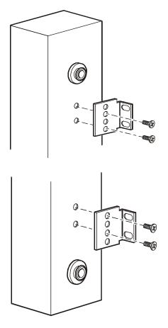
2. 用機櫃隨付的螺釘和籠形螺帽將機架 PDU 安 裝到機架或機櫃中的垂直安裝導軌上。
