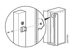
**水平安裝**. 您可以將機架 PDU 安裝到 19 英寸的 NetShelter 或其他 EIA-310-D 標準 19 英寸機架上:
