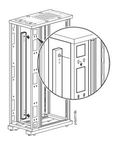
您可以使用免工具安裝的方法將兩個 PDU 固定在機櫃的一側。
