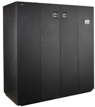
Liebert® XDC可以直接与Liebert® XD 制冷模块连接，控制充注式制冷剂的循环，确保制冷终端所需冷量，保持制冷剂温度始终高于机房露点，从而消除机房产生冷凝水的顾虑。多种散热方案可供选择。
